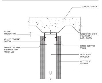
\*NOTE: SINGLE LAYER OF 5/8"TYPE "X" DRYWALL FOR 1 HOUR FIRE RATING, 2 LAYERS FOR 2 HOUR
