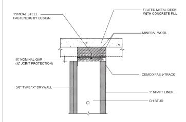
\*NOTE 1: SINGLE LAYER OF 5/8" TYPE "X" DRYWALL FOR 1 HOUR FIRE RATING, 2 LAYERS FOR 2 HOUR \*NOTE 2: NO FIRE SPRAY REQUIRED
