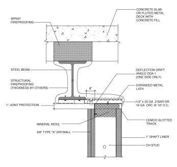
HW-D-0653 SHAFT WALL, PARALLEL & CANTILEVER UNDER BEAM
