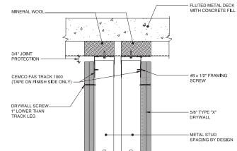
\*NOTE: SINGLE LAYER OF 5/8"TYPE "X" DRYWALL FOR 1 HOUR FIRE RATING, 2 LAYERS FOR 2 HOUR
